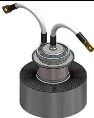
Генераторная лампа ITL15-2 представляет собой мощный триод с воздушным охлаждением анода, предназначенный для диэлектрического нагрева, применяются для генерации токов высокой частоты различной мощности. Эта электронная трубка с воздушным охлаждением предназначена для промышленных генераторов до 120 МГц.
